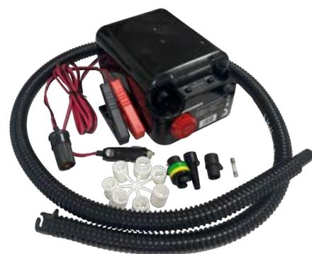
Gonfiatori a due stadi facili da usare. Il primo stadio, prodotto da una turbina, fornisce elevate portate d'aria a bassa pressione. Quando la turbina raggiunge una pressione di ~80 mbar, si spegne e avvia automaticamente il compressore a due stadi (che ha quindi un volume d'aria inferiore) per raggiungere la pressione massima di 300 mbar.
