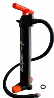
Gonfiatore manuale Super-F: più efficiente (meno sforzo) grazie al tubo esterno in alluminio. Manometro sul coperchio per una facile lettura. Porta di gonfiaggio sul corpo per evitare che il tubo si attorcigli. Inoltre, la Super-F ha una base pieghevole e le maniglie possono essere smontate per risparmiare spazio nella confezione.
