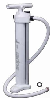
Gonfiatore manuale Super-F: più efficiente (meno sforzo) grazie al tubo esterno in alluminio. Manometro sul coperchio per una facile lettura. Porta di gonfiaggio sul corpo per evitare che il tubo si attorcigli. Inoltre, la Super-F ha una base pieghevole e le maniglie possono essere smontate per risparmiare spazio nella confezione.
